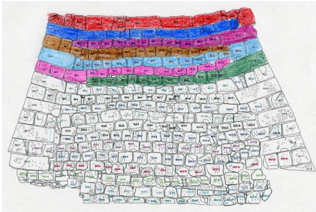
G 面石垣解体部分
